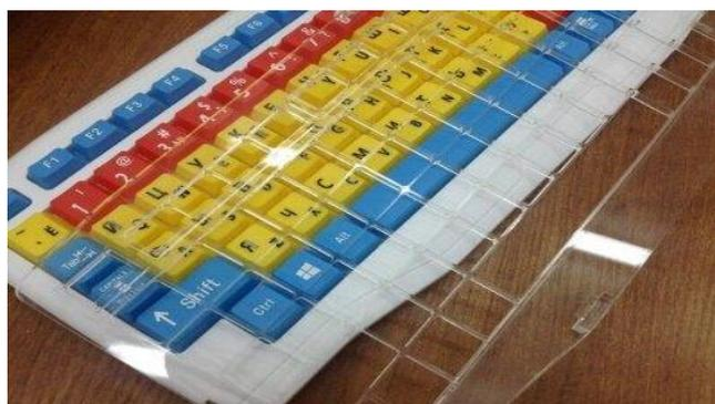
представляют собой пластмассовые или металлические наклейки, размещаемые поверх стандартной клавиатуры, облегчающие доступ к кнопкам. Накладки на клавиатуру дает возможность людям с плохой координацией рук нажимать только на необходимую кнопку. Это позволяет свободно и быстро работать на компьютере самостоятельно.
